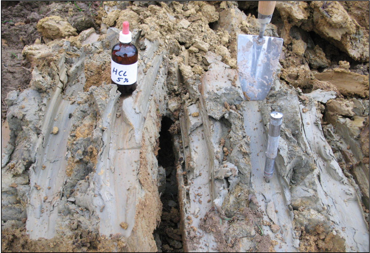
Foto 2: Schurf S 1: Graublauer, ausgeprägt plastischer Verwitterungslehm aus ca. 1,5-1,8 m Tiefe (Foto: 06.11.2017 HTR/TR)
