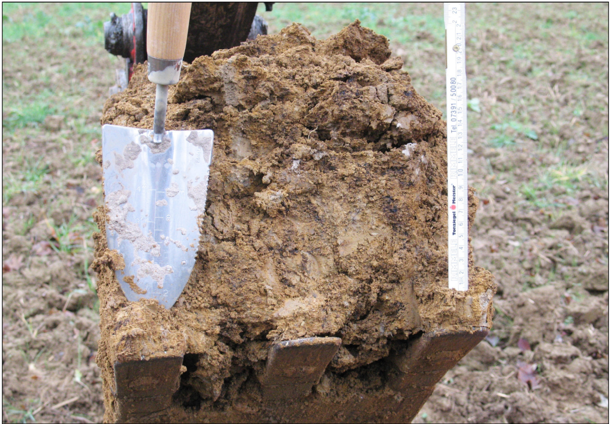
Foto 1: Schurf S 1: Lößlehm aus ca. 0,8-1,0 m Tiefe (Foto: 06.11.2017 HTR/TR)
